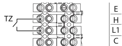
fig. 31 - Method B thermostat ( 1 zone)
