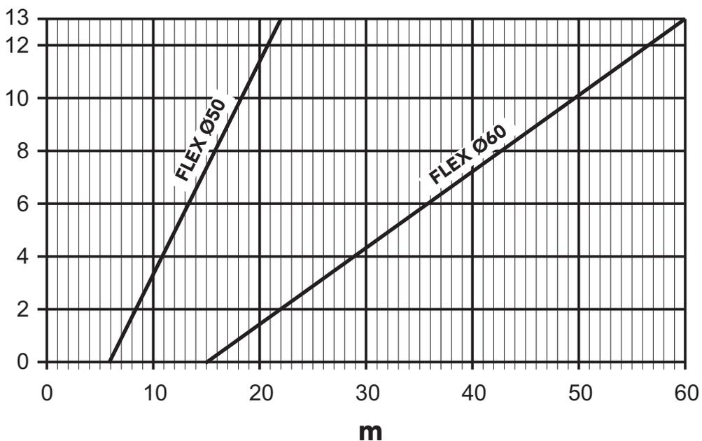
fig. 24 - Graph for choice of flue parameter
