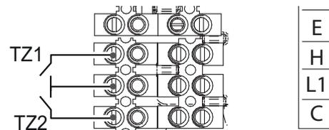
fig. 32 - Method C thermostat ( 2 zones)
